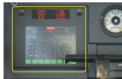
運転台に設置されたTNS車上装置
