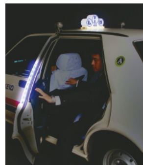
LEDランプを装着した左後部ドア
