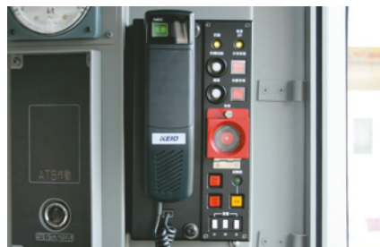
防護無線装置
