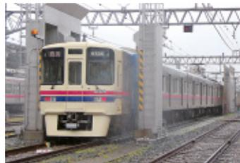
節水型車両洗浄装置
