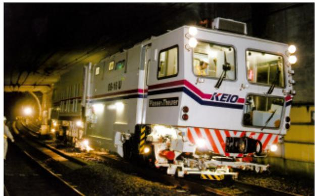
マルチプルタイタンパーによる道床のつき固め
