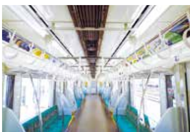
車両のLED照明
