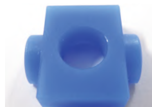
「バネ押さえ」の対策(材質を変更)
