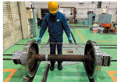
バックゲージ測定作業
