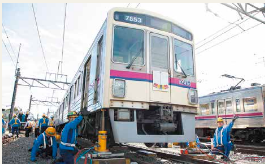
脱線車両の復旧
