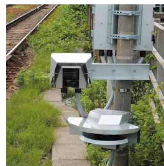
高機能型 (エリア検知式) 踏切障害物検知装置
