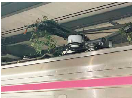
曲損したパンタグラフ
