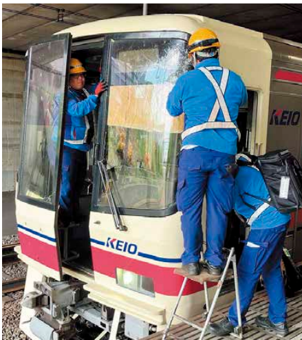
破損した前面ガラスの応急復旧
