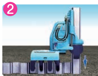
杭を鋼矢板圧入機が支えられる 深さまで土の中に押し込んでいく
