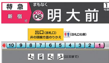
液晶画面を用いた車内案内表示器
