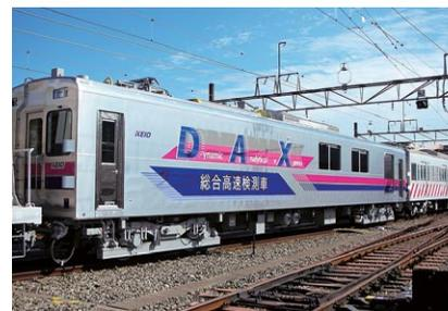
実際の列車と同じ速度で走行しながら、架線と軌道を同時に検測することができます。従来は、架線と軌道の検測は主に終電後の限られた時間に別々で行っていましたが、総合高速検測車は架線と軌道を同時かつ日中に検測できるため効率化されました。検測で得られたデータを保守計画に反映し、安全性・乗り心地の向上を図ります。
