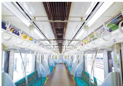
車両の客室内照明を蛍光灯からLEDへ置き換えるとともに、車両前照灯のLED化を進めています。これにより、明るさは変わらずに消費電力が従来に比べ約2分の1になる他、長寿命のため交換サイクルが長くなることから廃棄物の削減にもつながります。
