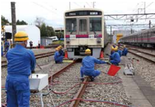
脱線車両の復旧
