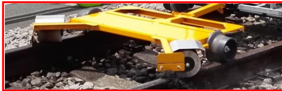
※カート前面のブラシで線路上の灰を除去
