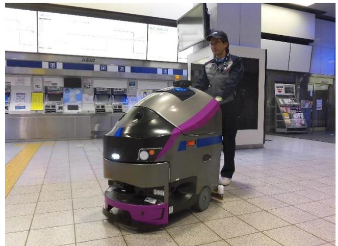
◀ 京王線5000系車両をイメージした自律走行式ロボット床面洗浄機 ▶
