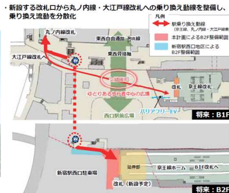
改札口の新設（地下2階）
