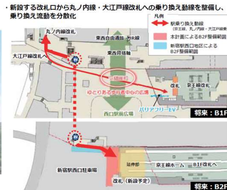
改札口の新設（地下2階）
