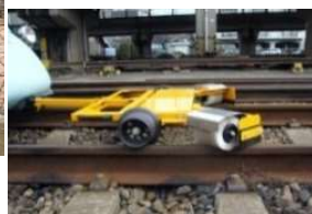
噴火対策 （除灰装置）
