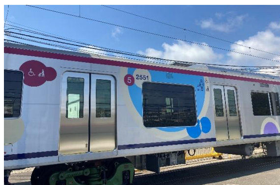
《5号車外観（大型窓を採用）》
