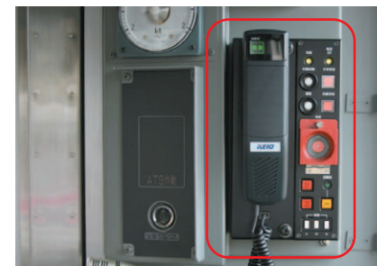
防護無線装置
