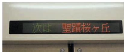
LED式の電光表示板
