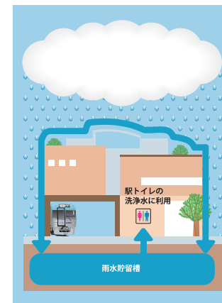
雨水利用システム
