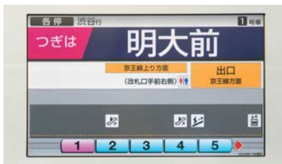
液晶画面を用いた車内案内表示器
