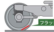
フラットによって生じる車輪の振動を自動的にセンサーで検知し、すぐに車両基地へデータが転送されます。
