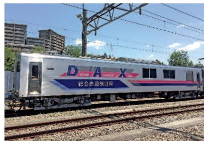
実際の列車と同じ速度で走行しながら、架線と軌道を同時に検測することができます。従来は、架線と軌道の検測は主に終電後の限られた時間に別々で行っていましたが、総合高速検測車は架線と軌道を同時かつ日中に検測できるため効率化されました。検測で得られたデータを保守計画に反映し、さらなる安全性・乗り心地の向上を図ります。
