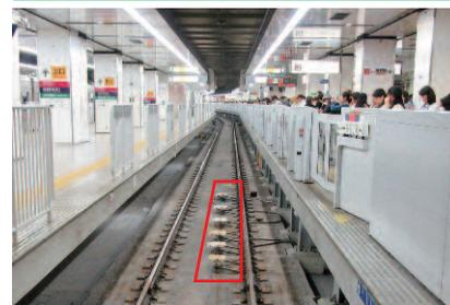
過走余裕距離が特に短い終端駅などに設置しています。複数の地上子がそれぞれ列車の速度を照査し、制限速度以上で列車が通過したときは非常ブレーキを作動させて列車を停止させます。
