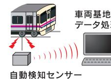
車両基地で車輪の削正や交換を行いフラットをなくし、騒音・振動・乗り心地を改善します。
