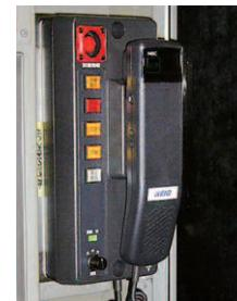
列車の脱線や踏切内での立ち往生などにより、他の列車の運行に支障を来す恐れがある場合、乗務員が乗務員室にあるボタンを押し、無線による信号を発報する装置です。この信号を受報した列車の運転士は直ちに列車を停止させ、事故を未然に防ぎます。
