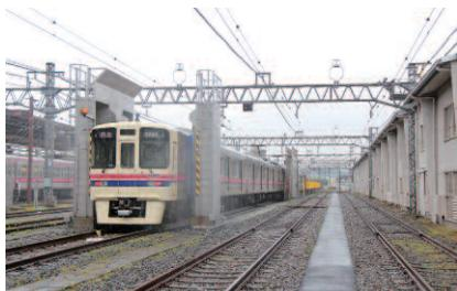
節水型車両洗浄装置
