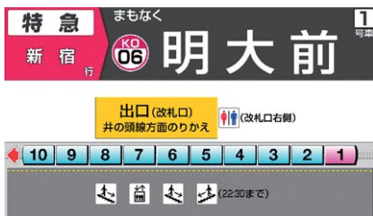
液晶画面を用いた車内案内表示器
