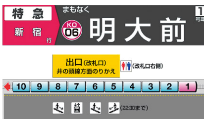
液晶画面を用いた車内案内表示器
