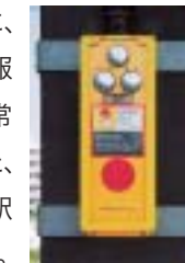
非常通報ボタン
