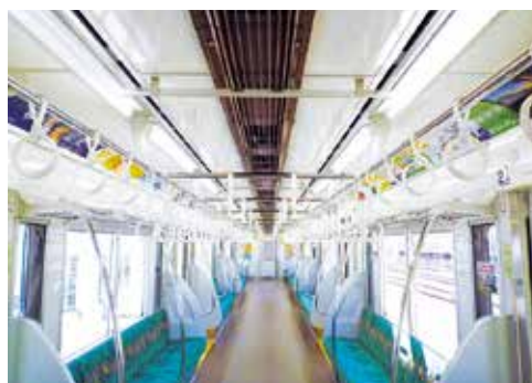
車両のLED照明
