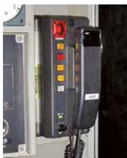
防護無線装置
