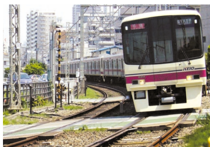
曲線を通る際には、定められた制限速度を超過しないよう、ATCが列車を制御します。
