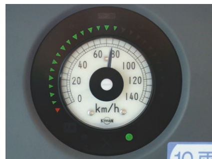
ATC化により、運転台の速度メーターには線路状況に応じた適正な速度が常に表示され(写真上の「0」表示)適正な速度を超過すると自動的にブレーキが作動します。
