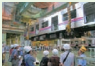
車両の吊り上げ
