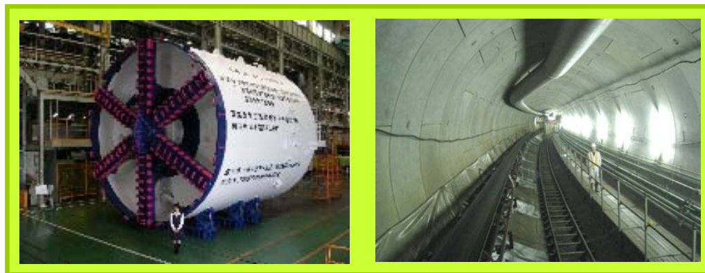
シールドマシン（左上） 掘削したトンネル（右上）
