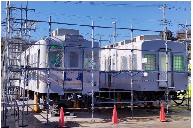
⑥ 12/4 外板修理中
