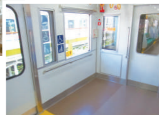
車内の車いす・ベビーカースペース
